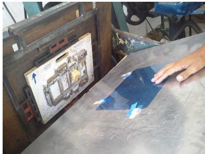
Figura 2 Corte de folha de acetato para fabricação de embalagens. Fonte: DPC Brasil (2012)
