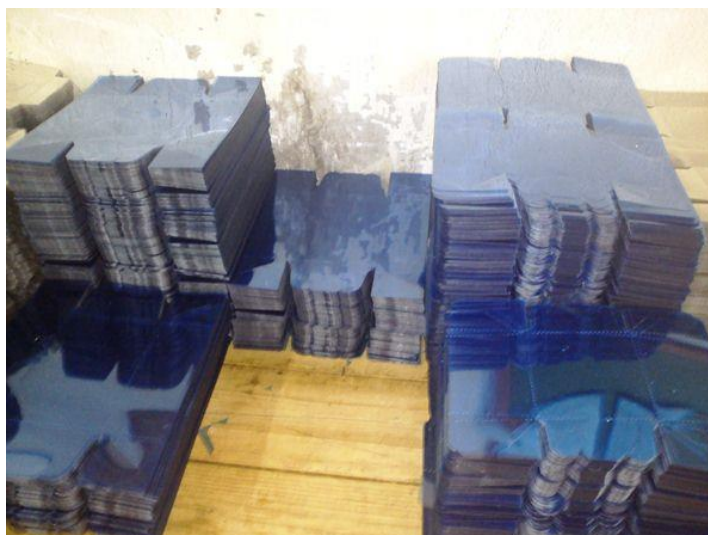
Figura 3 Folhas de acetato cortadas em moldes para embalagens.
