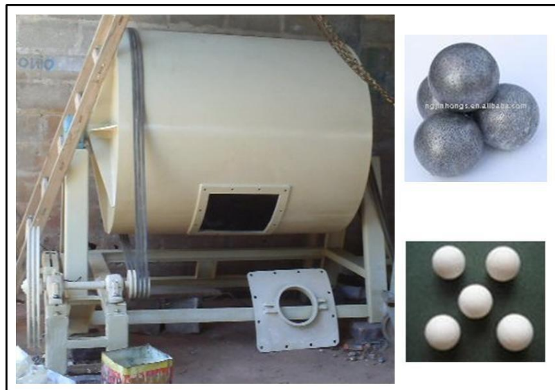
Figura 5 Exemplo de um moinho de bolas com capacidade de aproximadamente 1500 litros. No detalhe, à direita, esferas de aço (acima) e cerâmica (embaixo), ambas com 2 mm de diâmetro, que podem ser usadas como agentes de moagem. Fonte: Oliveira (2017).
